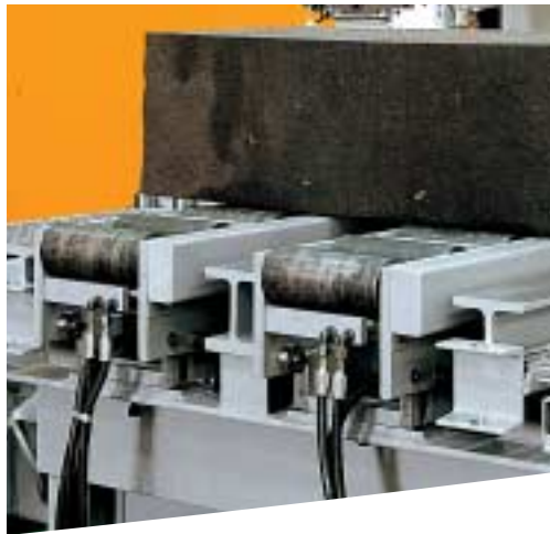
Auxiliaires de manipulation pour les blocs les plus lourds: rails à rouleaux relevables et abaissables par système hydraulique
