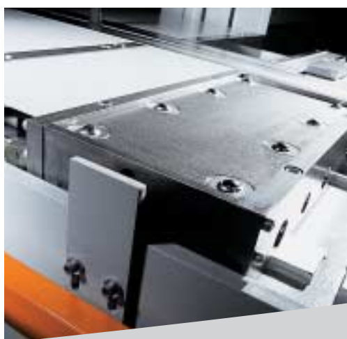
La manipulation des blocs et des tôles lourdes est un jeu d'enfant grâce à des tables à billes relevables et abaissables.
