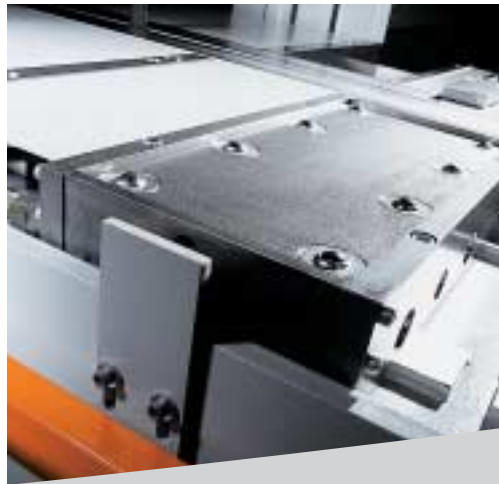
Leichtes Handling schwerer Blöcke und Platten durch hydraulisch heb- und senkbare Kugelrolltische.
