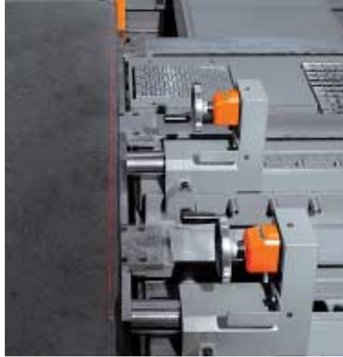
Mechanischer Werkstückanschlag, schnell und einfach einstellbar.
