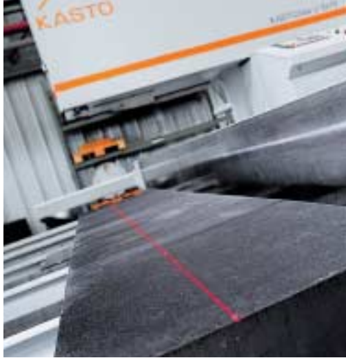
Laserlampe zur Projektion der Schnittlinie auf das Werkstück.
