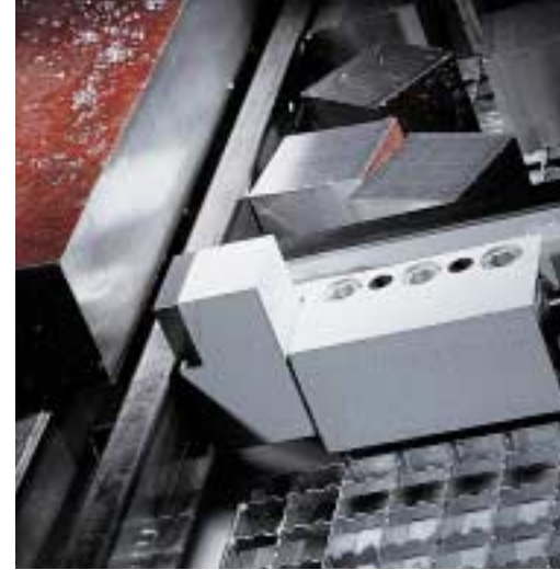
Hydraulischer Werkstückanschlag zur Positionierung von Platten bei Blockbandsägeautomaten.
