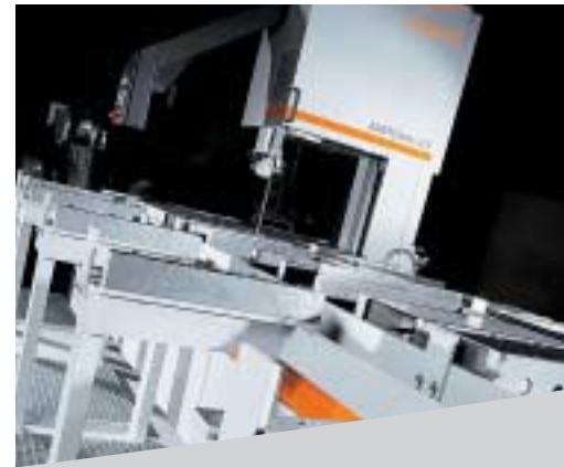
Außentischverbreiterung zur Verarbeitung groß dimensionierter Werkstücke.
