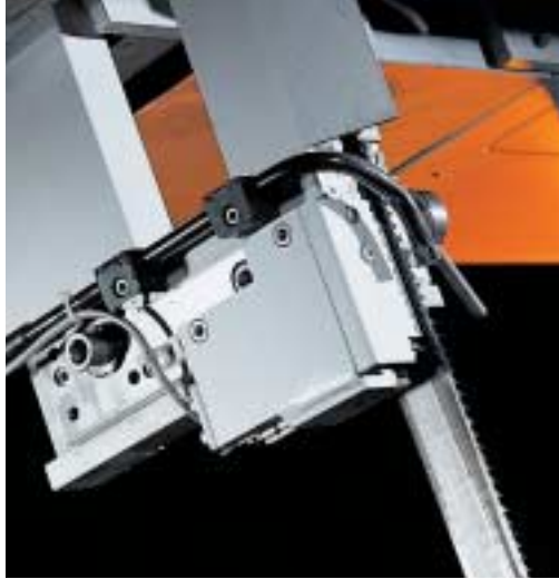
Hydraulische, elektronisch überwachte Sägebandspannung, obere Bandführung hydraulisch höhenverstellbar.
