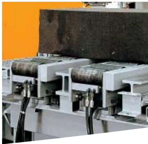
Handlinghilfe für schwerste Werkstücke: hydraulisch heb- und senkbare, angetriebene Rollenschienen.
