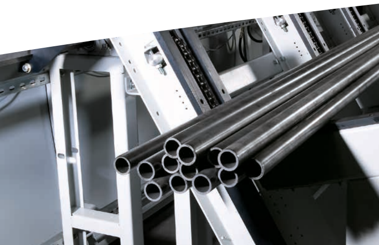
Bundlader mit Material in Ladeposition
