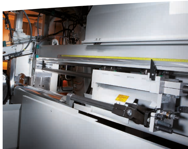
Manuell einstellbarer Messanschlag, z.B. mit 1.000 mm Abschnittlänge
