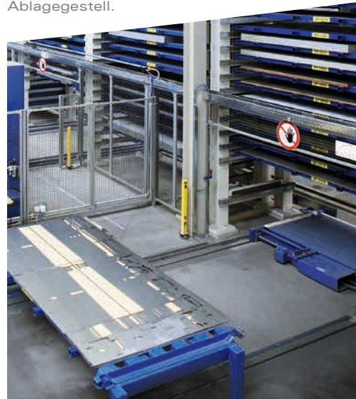
Querwagen mit Palettenhub und Ablagegestell.
