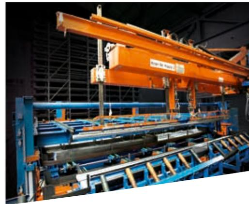
Kommissioniergerät mit Vakuumtraverse für nicht-magnetisches Langgutmaterial.
