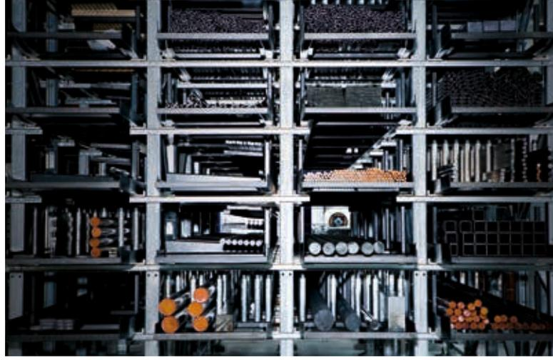
Blick in den Wabenlagerstahlbau mit Kassetten im Mischbetrieb (Automatik- und Standardkassetten).
