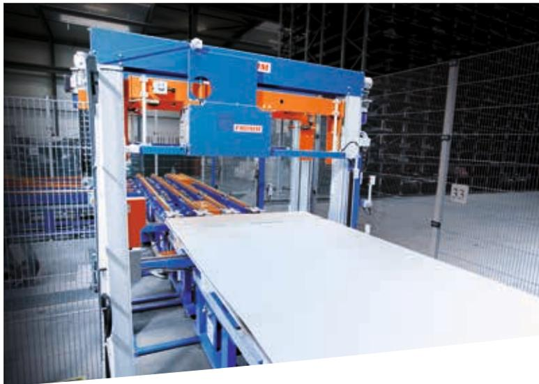
Vollautomatisch integrierte Umreifungseinrichtung mit Förderanlage.
