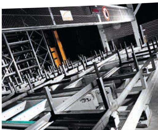
Pufferstation an der Lagerlängsseite mit 14 Pufferplätzen.
