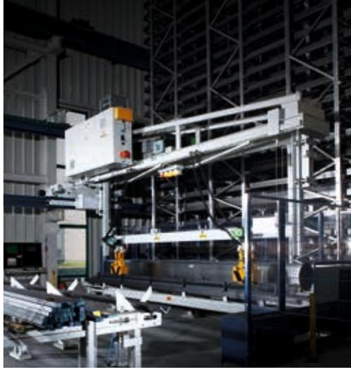
KASTO Kommissioniergerät mit Magnetanlage.
