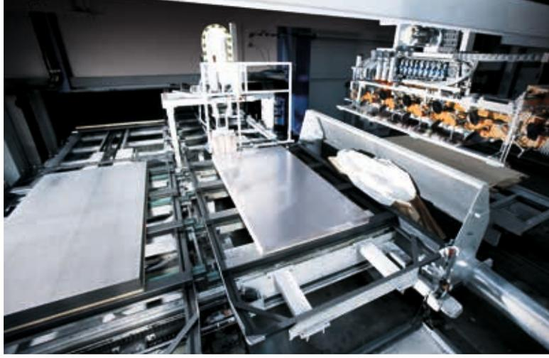
Umlaufstation mit vollautomatischer Blechkommissionierung.
