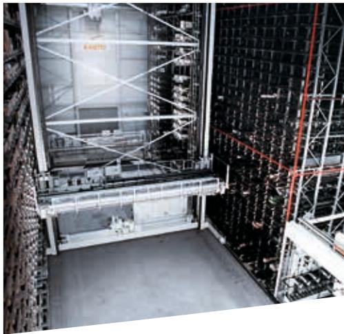
Wabenlager mit Sägezelle als Logistikzentrum für Langgut, Blech, Europaletten mit Sägezelle.
