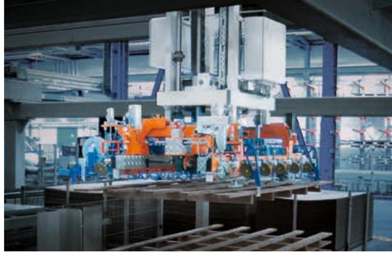
Blech-Manipulator in vollautomatischer Ausführung.
