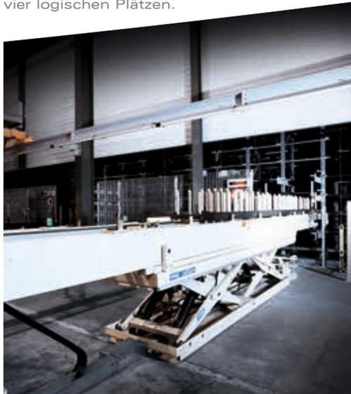
Umlaufstation an der Lagerlängsseite mit Umreifungseinrichtung und Materialbündelförderer.
