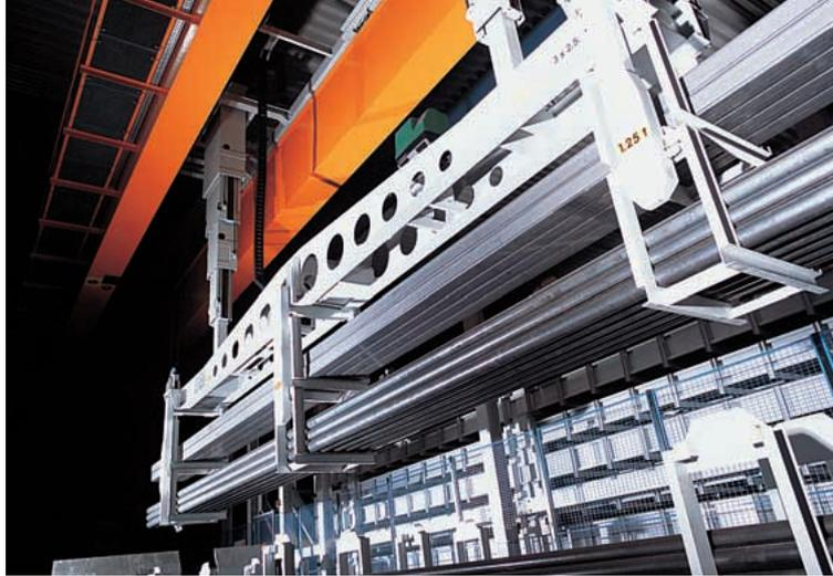
Schneller Transport: Mehrfachtransporttraverse mit 3 Aufnahmepaaren und Teleskopführung beim Transport von 2 Lagerplätzen.
