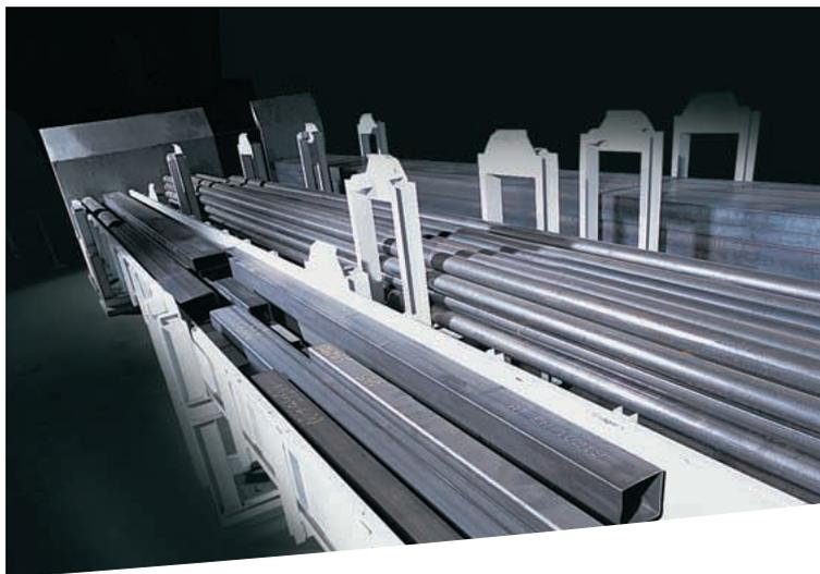
Flexible Lagerung: Durch den Einsatz von Stapeljochkassetten können selbst Reststücke optimal gelagert werden.
