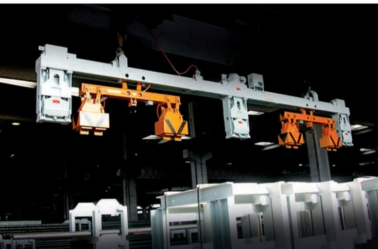
Nach Einklappen der Greiferarme können einzelne Stäbe sicher und schnell kommissioniert werden.
