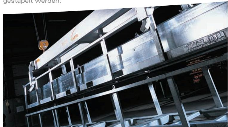
Magnetisch: Mit der *UNIBLOC F* Magnettraverse können Stapeljochs sicher manipuliert werden.
