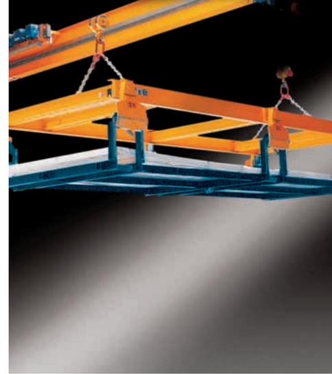
Transportjoch **BLECH**: Zur Lagerung von Blechpaketen und Platten in den unterschiedlichsten Formaten.
