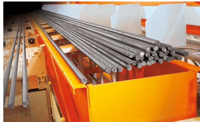
Querstation-Kettenförderer mit Aushub
