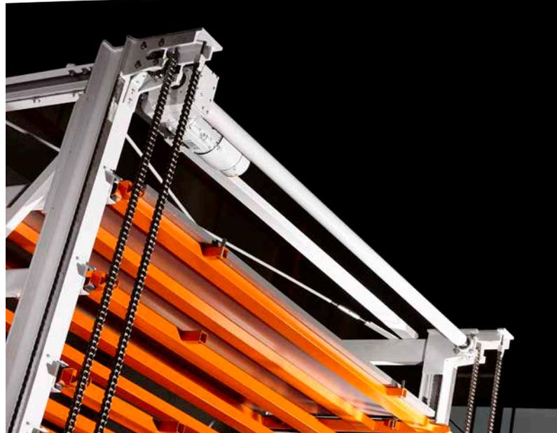
Stationärer Hubwerksantrieb mit Gleichlaufwelle
