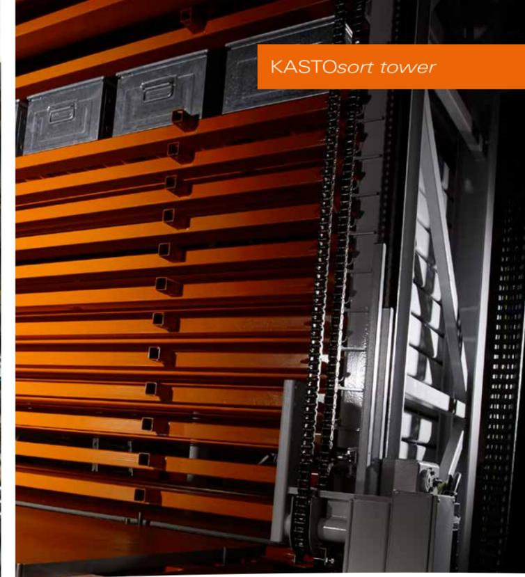
andere KASTO-Sägen anzubinden, wie beispielweise den Hochleistungsbandsägeautomaten KASTOtec. Das Turmlager KASTOecostore bietet eine optimale Raumnutzung nach oben, eine hohe Lagerdichte, Flexibilität bei der Materialaufnahme und kurze Zugriffszeiten. Der Platzbedarf liegt bei etwas mehr als elf Quadratmetern.
