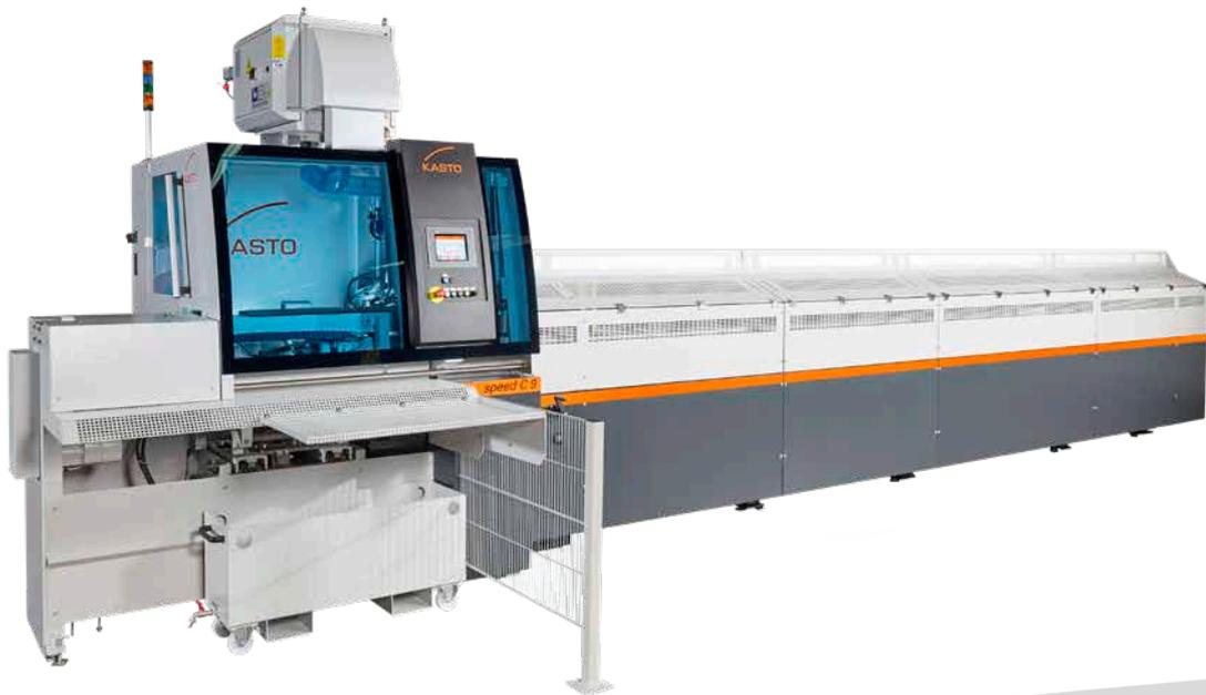
Großserien im Dauerbetrieb fertigt die KASTOspeed 9, wenn es sich um Abschnitte aus Stahl oder NE-Metallen mit einem Materialquerschnitt bis zu  $\varnothing$  90 mm handelt. Je nach Zerspanbarkeit des Werkstoffes und der Produktionsanforderungen werden HSS-Vollstahlder Hartmetall-Einweg-Sägeblätter mit angepassten Schnittgeschwindigkeiten eingesetzt.
