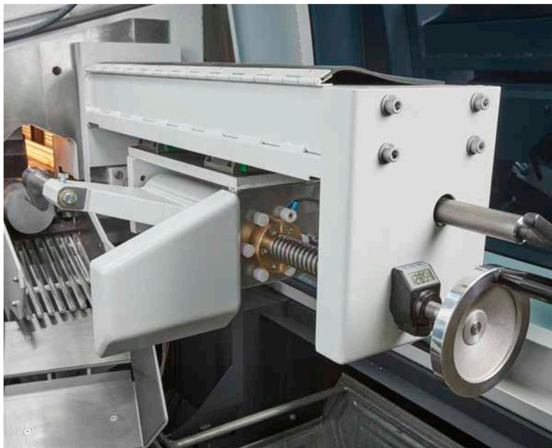
Doppelrollenbahn für automatischen Materialwechsel
