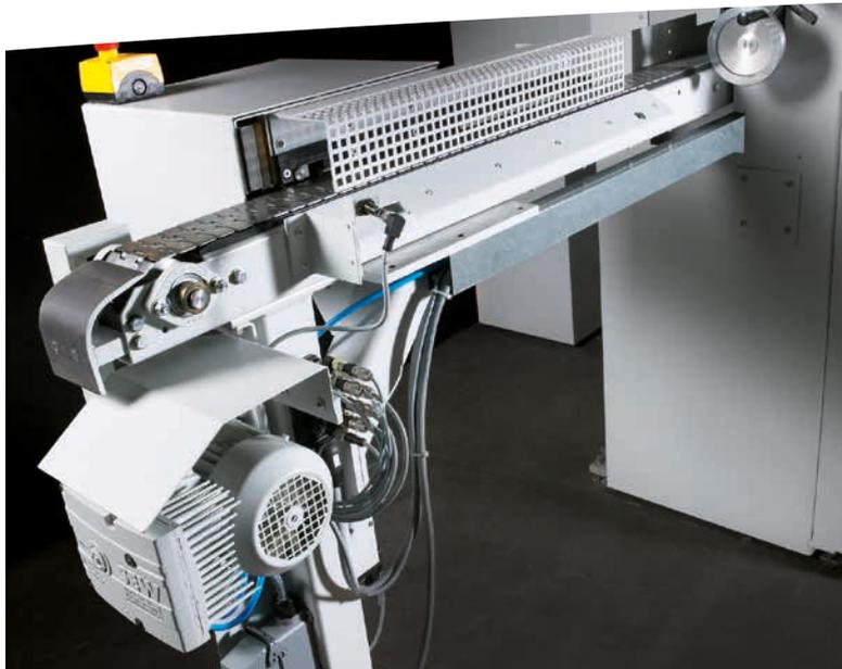
Abschnitt-Abfuhrband mit Schiebeeinrichtung (Ausführung „nach links“)
