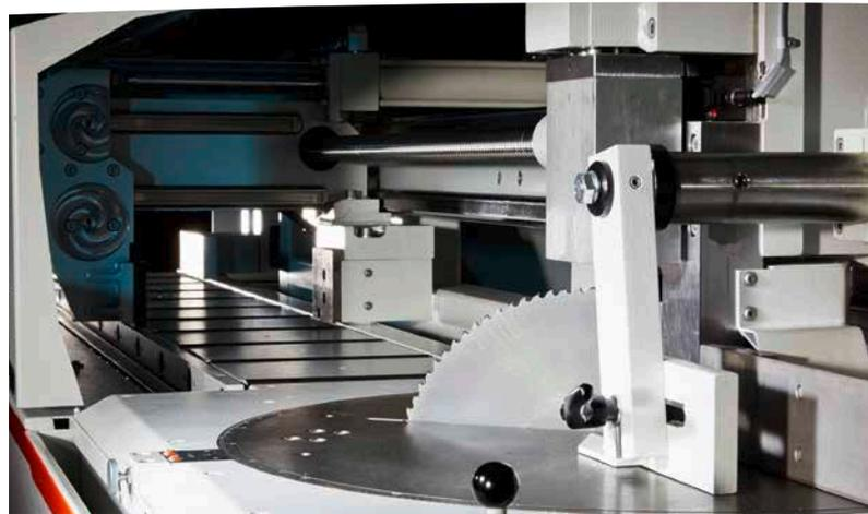
KASTOflex A: Vertikalspannstock und Materialvorschubeinheit
