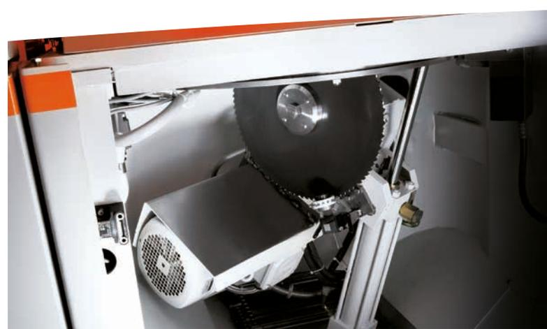
Großzügiger Zugang für einfachen Sägeblattwechsel
