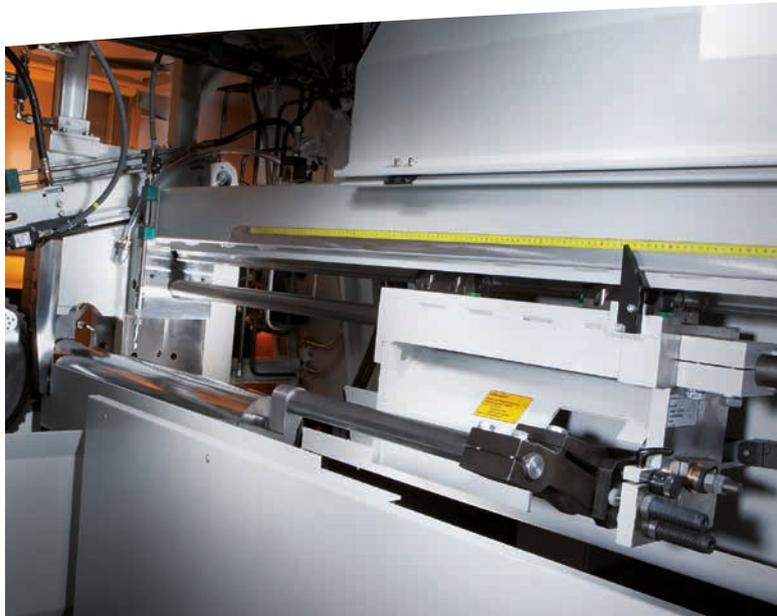
Manuell einstellbarer Messanschlag, z.B. mit 1.000 mm Abschnittlänge
