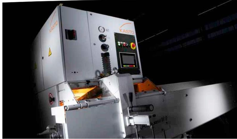
Maschinensteuerung mit Technologieeingabe über Touch-Screen
