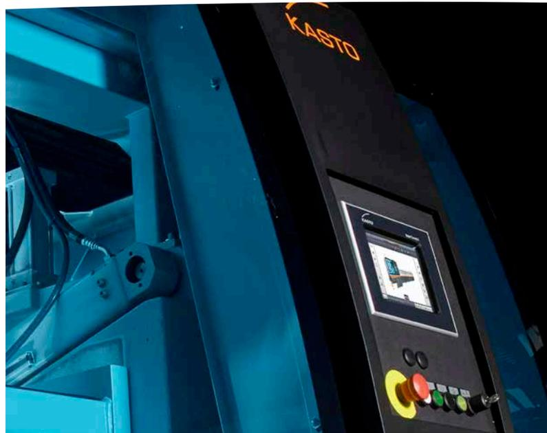
Maschinensteuerung mit Technologieeingabe über Touch-Screen
