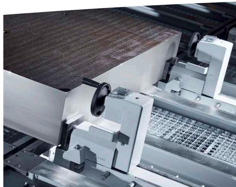
Mechanischer Werkstückanschlag, schnell und einfach einstellbar.
