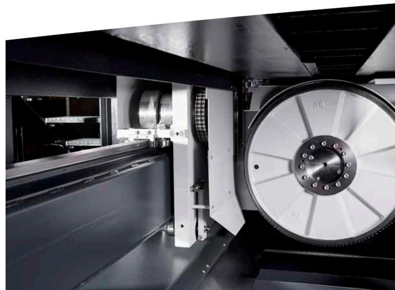
Das Sägeaggregat verfährt auf gehärteten Laufrollen auf verschleißfesten Laufschienen.
