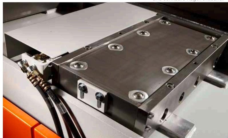
Außentischverbreiterung zur Verarbeitung groß dimensionierter Werkstücke
