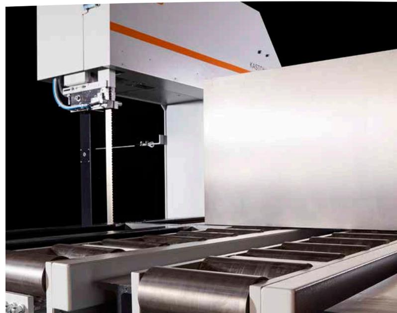
Handlingshilfe für schwerste Werkstücke: hydraulisch heb- und senkbare, angetriebene Rollenschienen.
