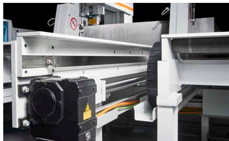
Steckbare Spannvorrichtung mechanisch.
