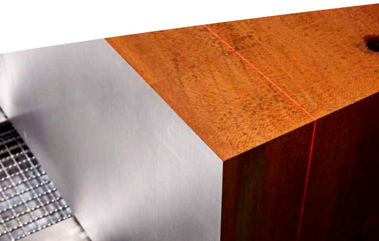
Laserlampe zur Projektion der Schnittlinie auf das Werkstück.
