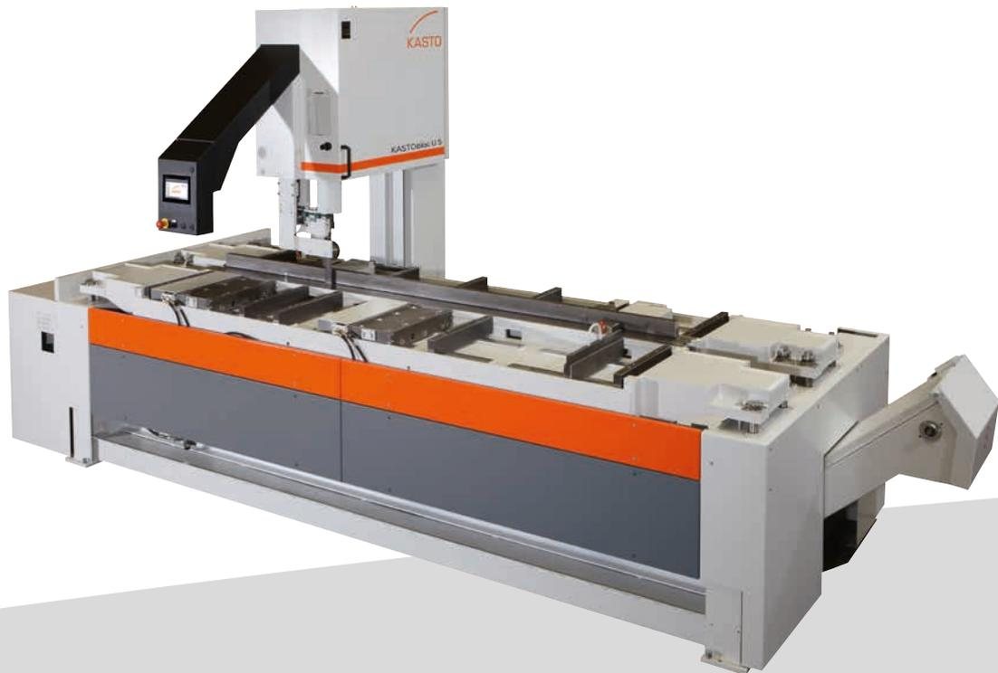
Mit den KASTO Plattenbandsägemaschinen KASTObloc A und U können aus Walzblöcken oder -platten, Vierkant- oder Flachmaterialien mit unterschiedlichen Querschnittmaßen konfektioniert werden. Möglich ist dies durch die Langschnittarbeitsweise der Sägen. Unter Verwendung von Bi-Metall- oder Hartmetallbändern können alle Materialqualitäten, einschließlich schwer zerspanbarer Werkstoffe, wie Titan, Hastelloy oder Inconel mit einer hohen Zerspanungsleistung gesägt werden.
