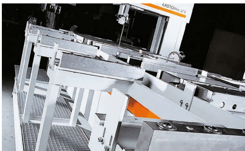
Élargissement de la table externe pour l'usinage de pièces de grandes dimensions.
