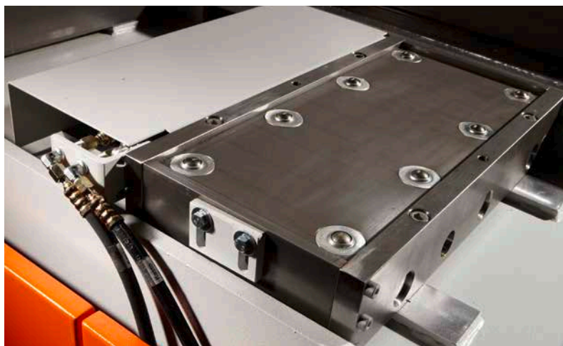
Élargissement de la table externe pour l'usinage de pièces de grandes dimensions.
