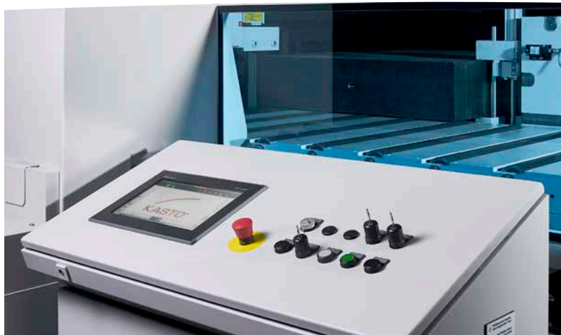
Pupitre de commande de la KASTObloc A avec KASTO ProControl
