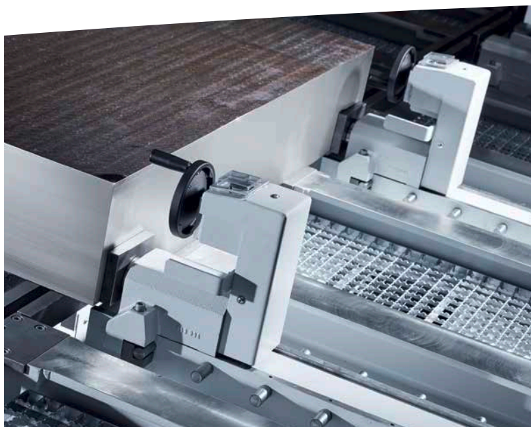
Butées de mesure mécaniques, avec réglage rapide et aisé.
