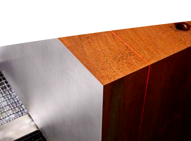
Lampe laser pour la projection de la ligne de coupe sur la pièce à usiner
