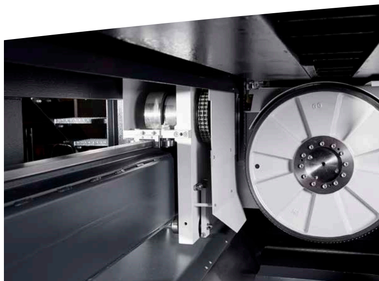
Le groupe de sciage se déplace sur des rouleaux trempés avec des rails résistants à l'usure
