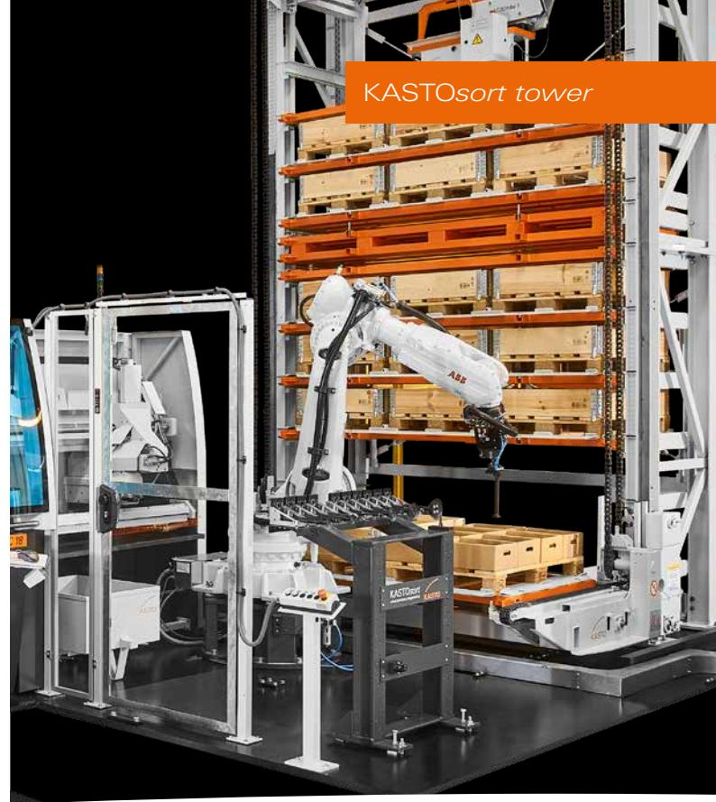
KASTOvariospeed, d'un robot KASTOsor et d'un système de stockage KASTOecostore. Il est également possible de raccorder d'autres scies KASTO, comme par exemple la scie à ruban automatique à haut rendement KASTOtec. La tour de stockage KASTOecostore permet une utilisation optimale de l'espace en hauteur, une densité de stockage élevée, une flexibilité dans la collecte des matériaux et des délais d'accès courts. L'encombrement est d'un peu plus de onze mètres carrés.
