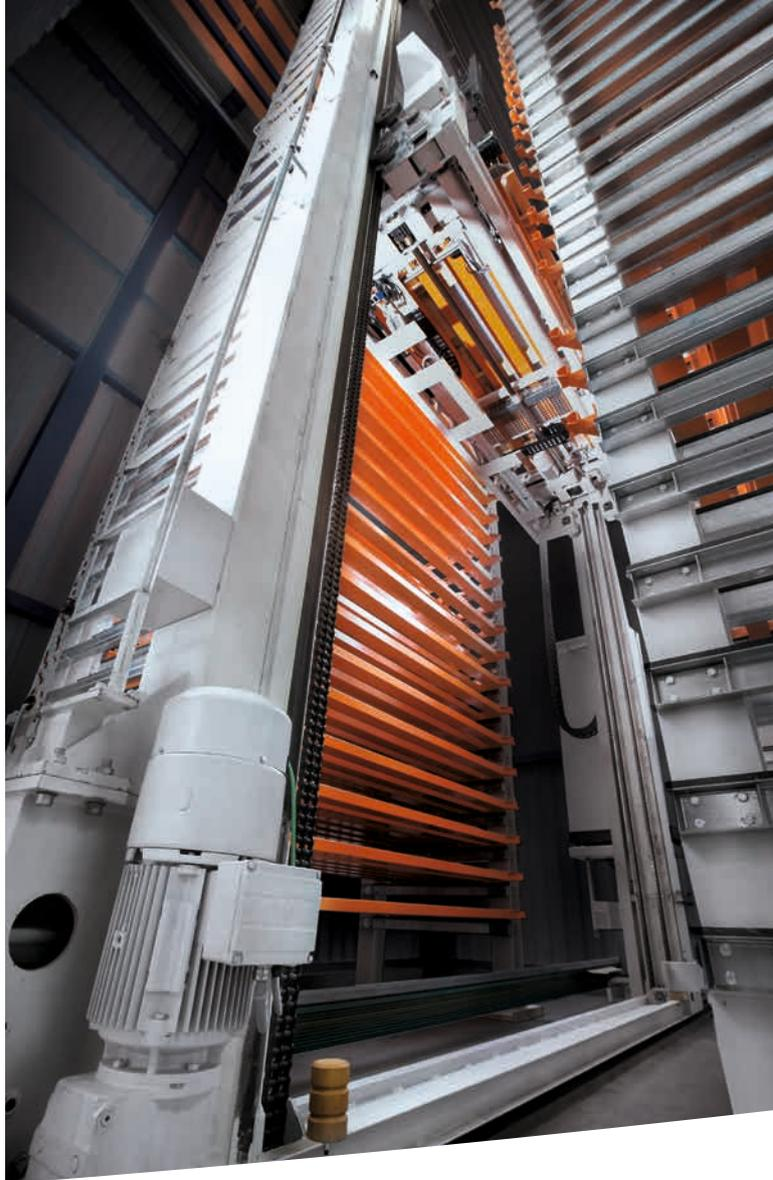
Transstockeur avec dispositif de levage à chaînes éprouvé.
