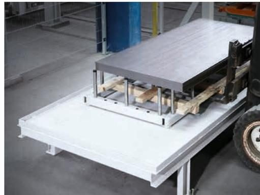
Station d'alimentation et de déchargement raccordée à une machine poinçonneuse et laser.
