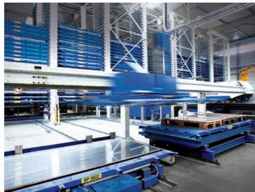
Double chariot pour l'alimentation et le déchargement de machines à découper au laser.
