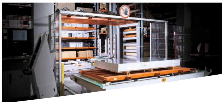
Station d'emmagasinement et de sortie matières conçue pour deux formats de palettes différents pour un stockage universel de divers produits.
