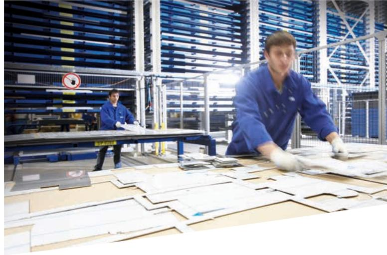
Deux châssis de dépose en tant que postes de travail manuel.
