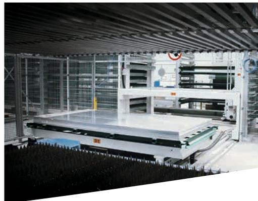
Station rotative pour l'alimentation d'une poinçonneuse.
