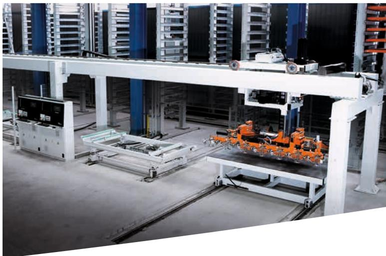
Station automatique de préparations de commandes avec installation de transport à vide.
