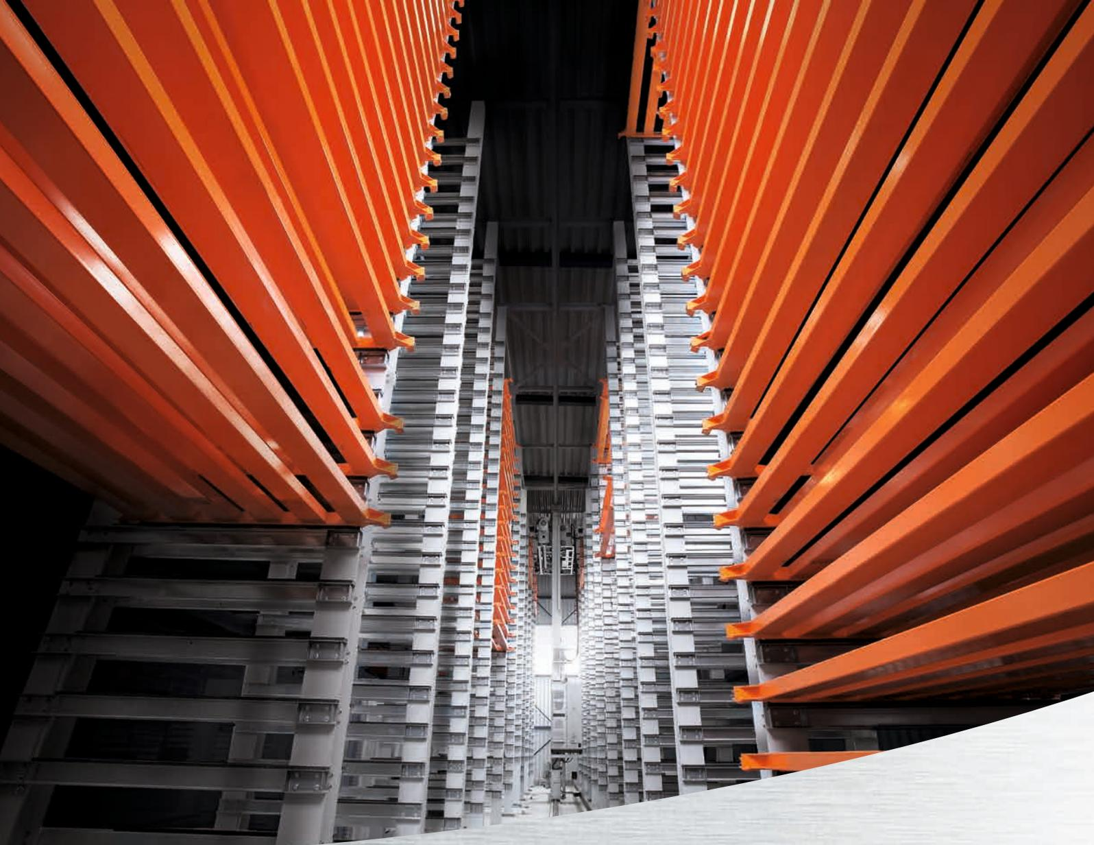
*UNILINE*: Magasins de stockage en longueur pour un approvisionnement efficace en matière des machines d'usinage et pour les préparations de commandes.
