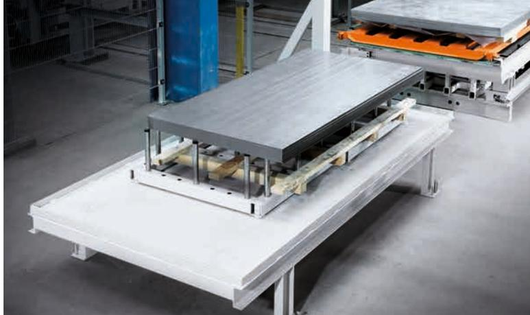
Table pour dépaqueter avec châssis mobile ainsi qu'une station d'emmagasinement et de sortie.
