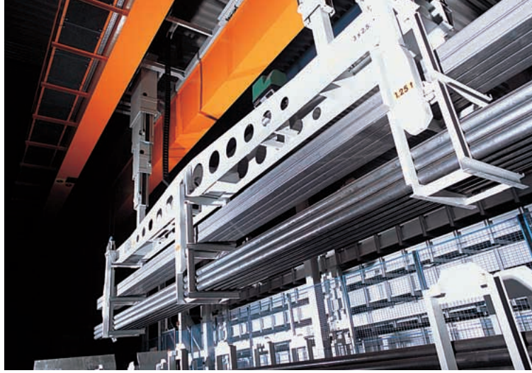
Transport rapide: Palonnier de transport multiple avec 3 paires de bras d'accrochage et guides télescopiques lors du transport de deux emplacements de stockage.
