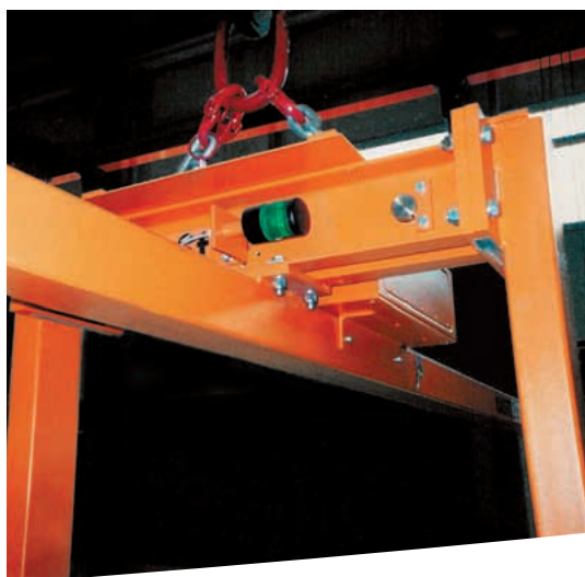
Indicateur optique sur le système d'accrochage pour une manutention rapide et sûre.
