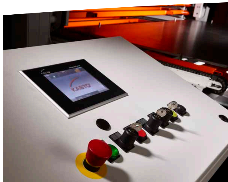
KASTO AdvancedControl avec choix de compartiment et touche de validation
