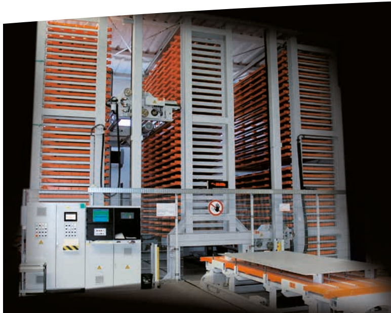
UNITOWER B, avec une extension à deux transstockeurs
