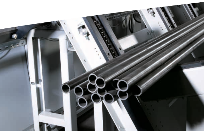
Débotteur avec matière en position de chargement.
