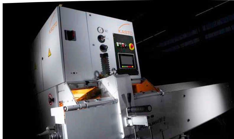
Commande de la machine avec saisie des données par écran tactile
