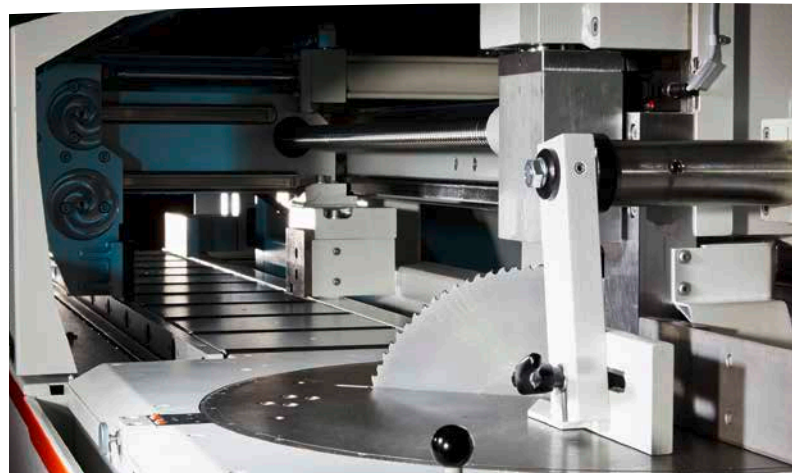
KASTOflex A : Étau vertical et unité d'avance du matériau
