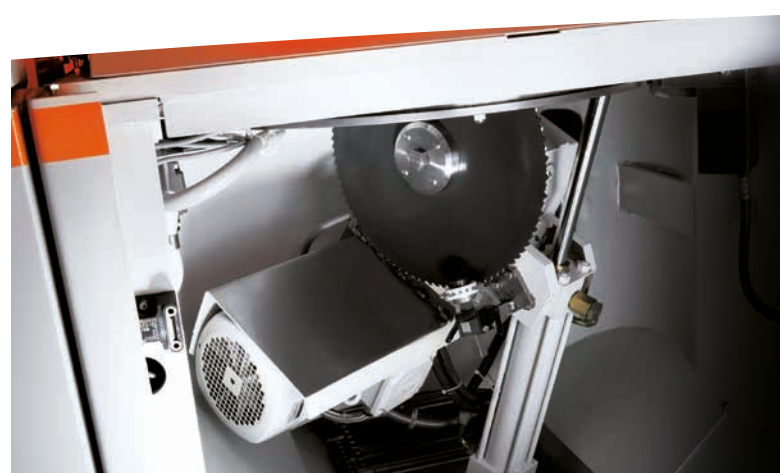
Bonne accessibilité pour un changement facile de lame
