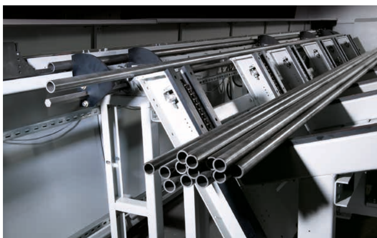
Débotteleur avec matière en position de chargement
