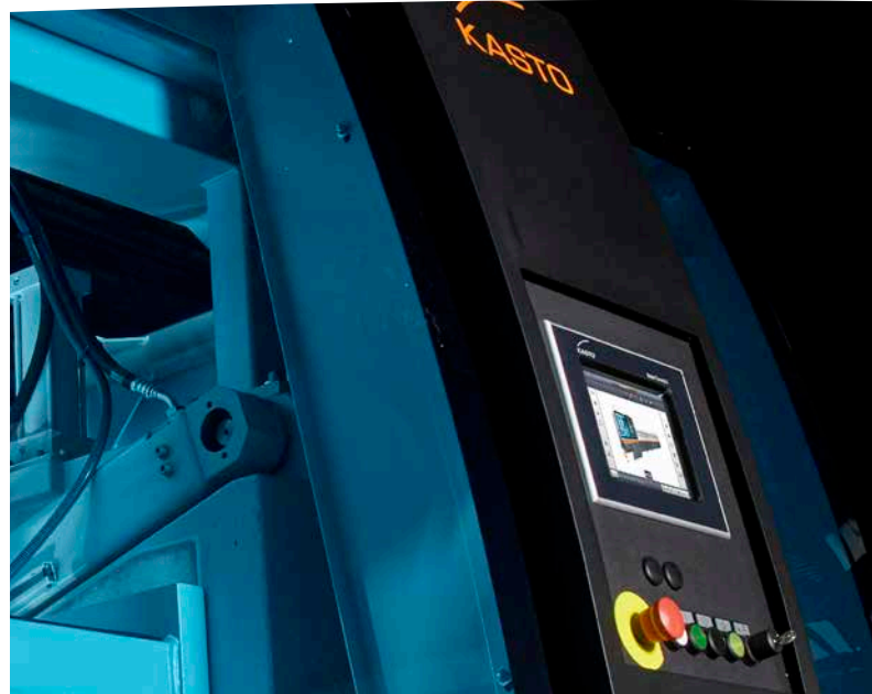
Commande de la machine avec saisie de technologie par écran tactile
