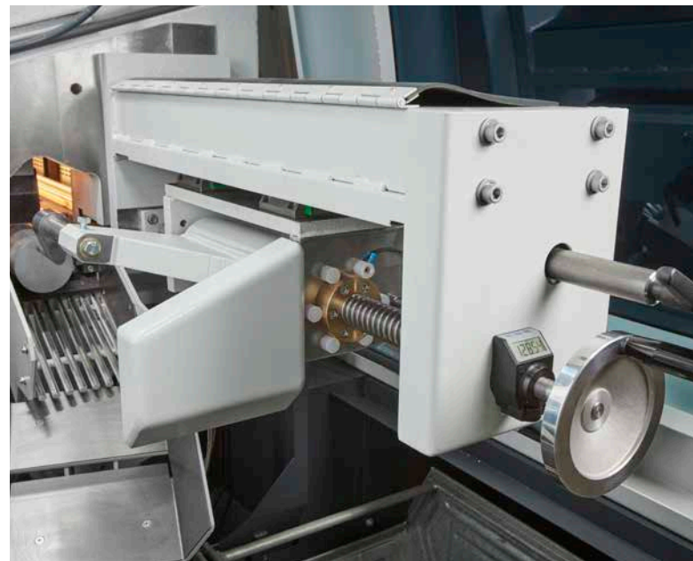
Butée de mesure réglable manuellement, par ex. pour une longueur de coupe de 1 000 mm
