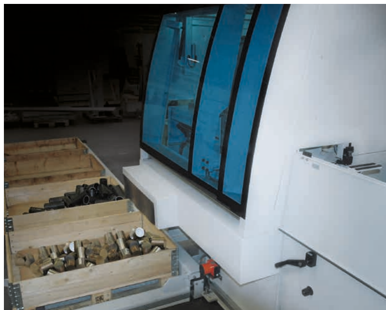
Glissoir trieur pour chutes, bonnes pièces et coupes entames
