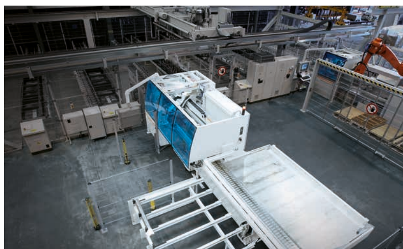
Tri des tronçons de grande longueur en dehors de la machine.
