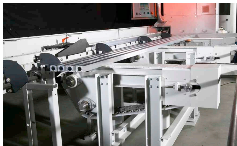
Magasin plat pour profilés rectangulaires et spéciaux
