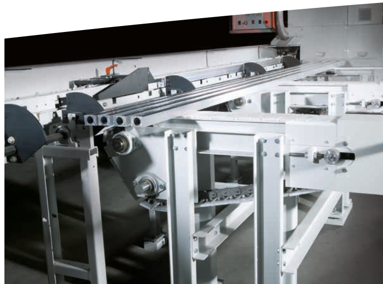
Magasin plat pour profilés rectangulaires et spéciaux
