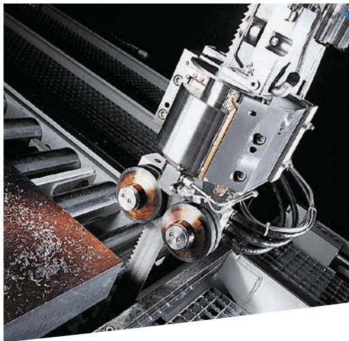
En position 0°, la machine KASTObbs scie le long du convoyeur.
