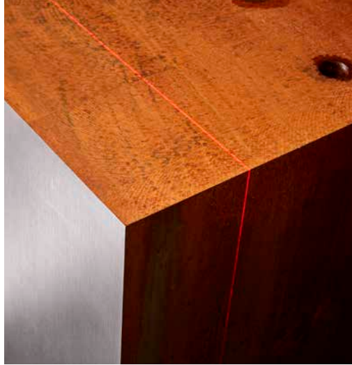
Rayon Laser pour projeter la ligne de coupe sur la pièce.
