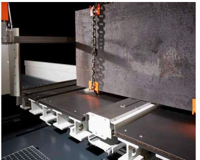
Richteinrichtung, hydraulisch heb- und senkbar sowie quer verschiebbar
