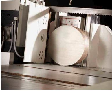
Die optionalen Magnetspannplatten halten Reststücke zuverlässig in Position.
